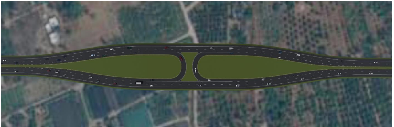
รูปที่ 6-34 ตัวอย่างรูปแบบจุดกลับรถระดับพื้น (บริเวณนอกเขตชุมชน) สำหรับรถทุกประเภท
